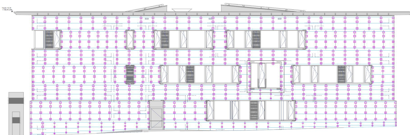
Verlegeplan der zertifizierten Komponente an der Referenzfassade
