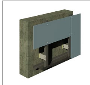
Lüftungsprofil / unterer Abschluss
